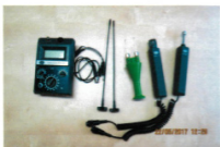
Gann Hydromette RTU 600 Mögliche Messungen: Lufttemperatur und relative Luftfeuchte Holzfeuchte Bauteilfeuchte an der Oberfläche Bauteilfeuchte Tiefenfeuchte (Bohrungen erforderlich)
