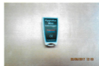
Hygrofox Mini Datenlogger Langzeitaufzeichnung von Lufttemperatur und relativer Luftfeuchtigkeit
