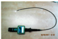
Endoskopkamera Ermöglicht Einblicke und Bild oder Videoaufnahmen an schwer zugänglichen Stellen. Inspektion von Abflüssen, Rohren, Leitungen, Luftschächten usw.
