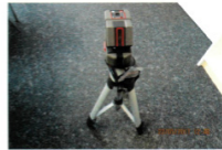
Lasernevellier Feststellung von Unebenheiten auf Betondecken, Estrichflächen und Flachdächern
