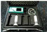
Mikrowellenfeuchtigkeitsmessgerät Hf-Sensor Ermöglicht Messungen der Feuchtigkeit im Baustoff - eine zerstörungsfreie Messmethode.
